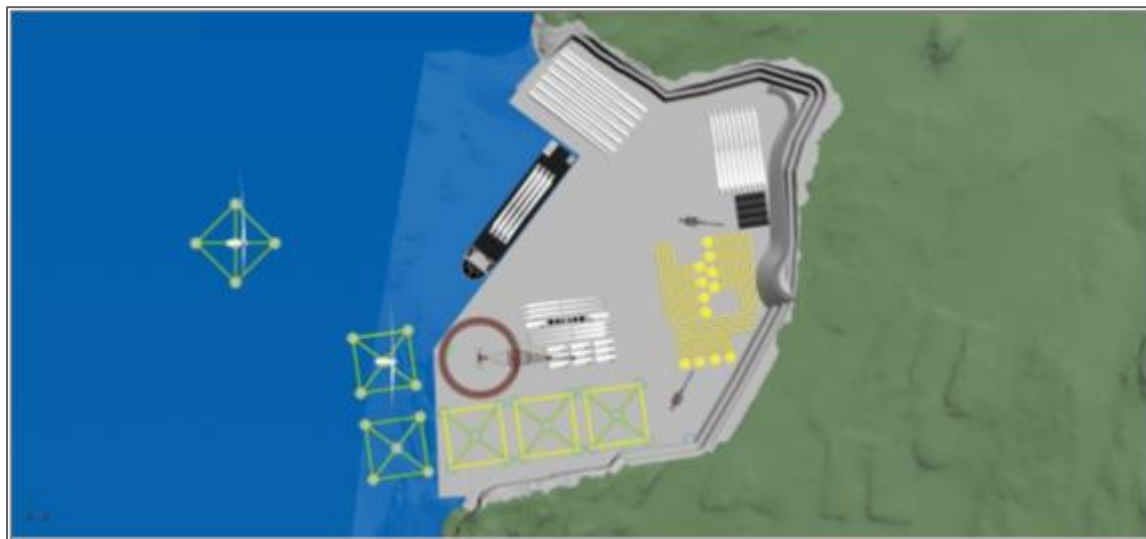
Figur 5 Området sett ovanfra (Fase 1+2). Her viser tilkomstvegen ned til området. Deler til seks komplette 15 MW møller ligg lagra på området; Tårn, naceller, rotorblad og fundament. To kraner (Crawler crane) flytter delane rundt på området. Den store ringkrana samanstillar til komplette møller. Det er også plassert fire lagerbygningar (mørkegrå) på området. (Kjelde: Forslag til planprogram, kap. 3.1)
