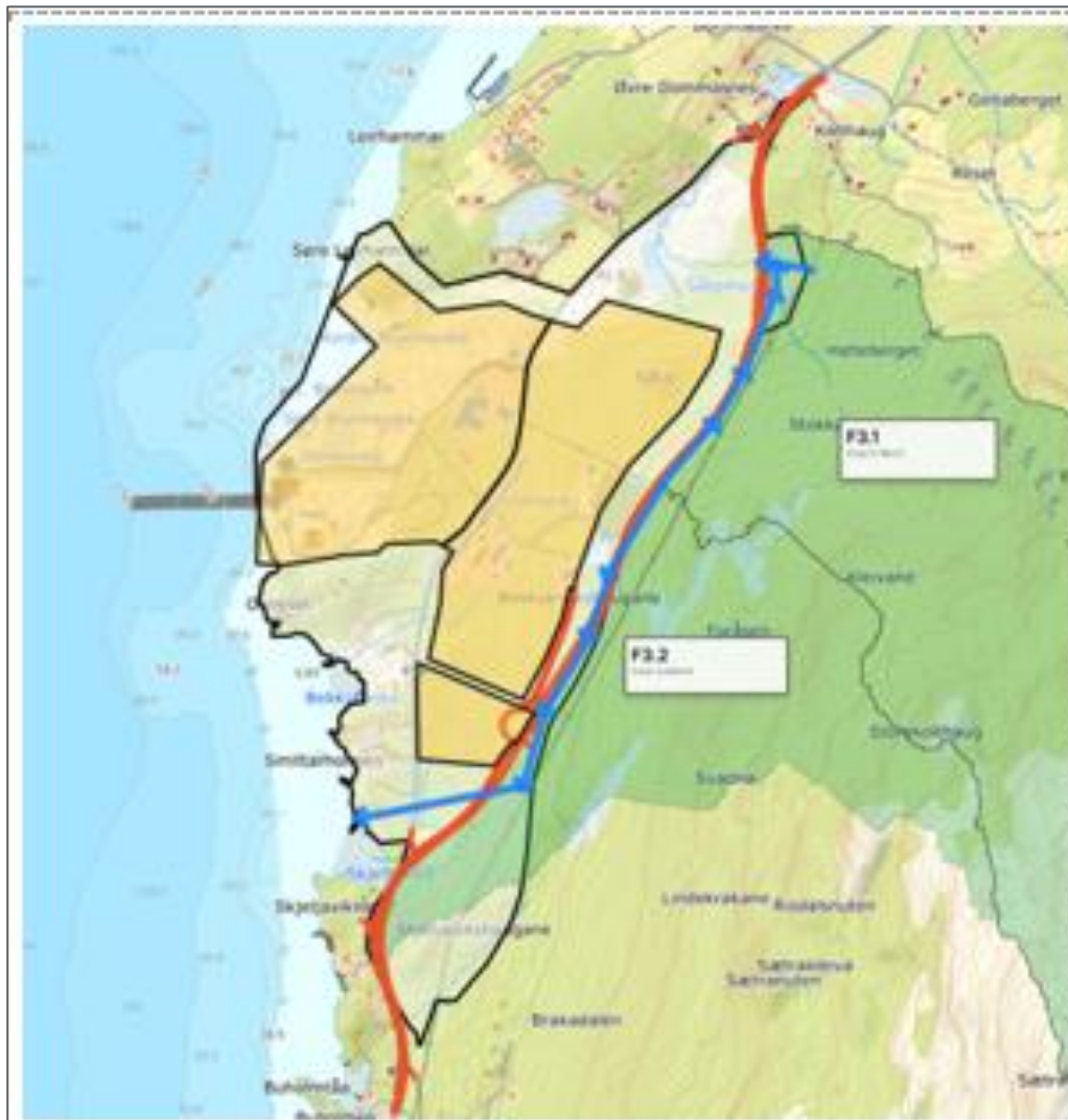
Figur 63 Framtidig situasjon med moglege tiltak. Den nye fylkesvegen er markert i oransje og foreslått tiltak for leiing av overvatnet er markert med blå piler. Henta frå Sca.lgo Live.
